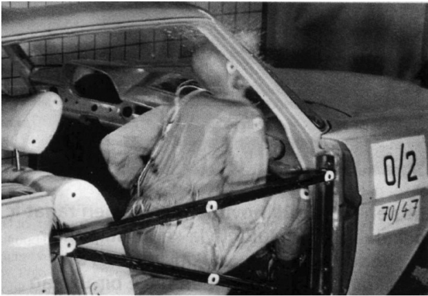
Resim 1. Önde oturan yolcunun ön konsola ve ön cama çarpması sonucu yaralanma
